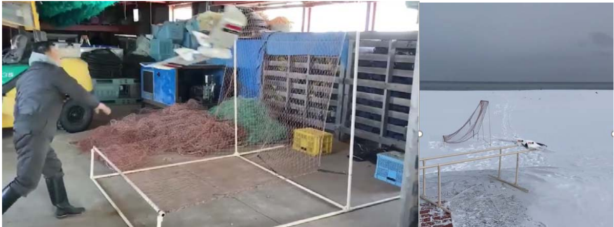
図. 漁網を使った着陸用ネットへの衝突風景(上、左下)と発射台(右下)
