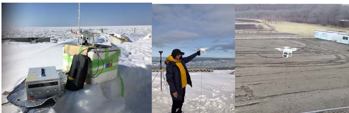
図. 変圧機と有線ドローン(左)、飛行準備で GPS 取得(中)、飛行中(右)
